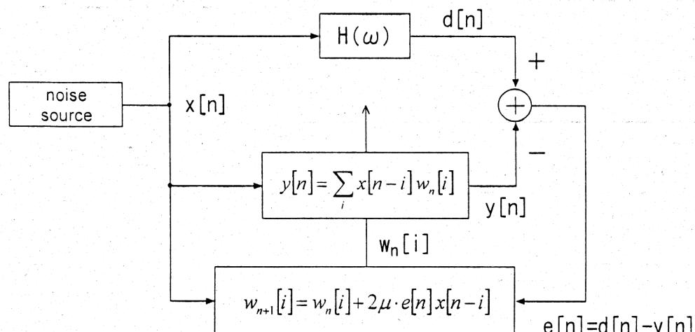
適応フィルタ = デジタルフィルタ (FIR) + フィルタ係数更新処理
